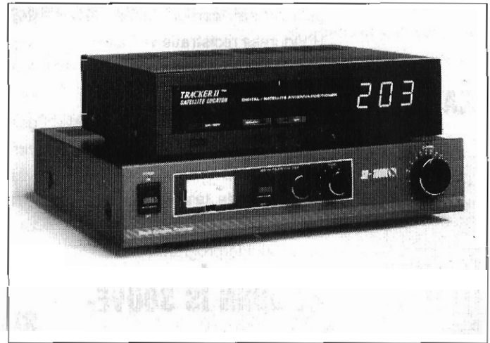
Eenvoudige, maar zeer doeltreffende basis-set: onder de handbediende ontvanger met daarop de eveneens handbediende motorsturing voor het draaien van de schotel.
