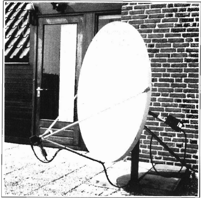
De schotel kan vrij eenvoudig op de grond geplaatst worden, maar moet 'vrij zicht' hebben op de zuidelijke hemel ...
